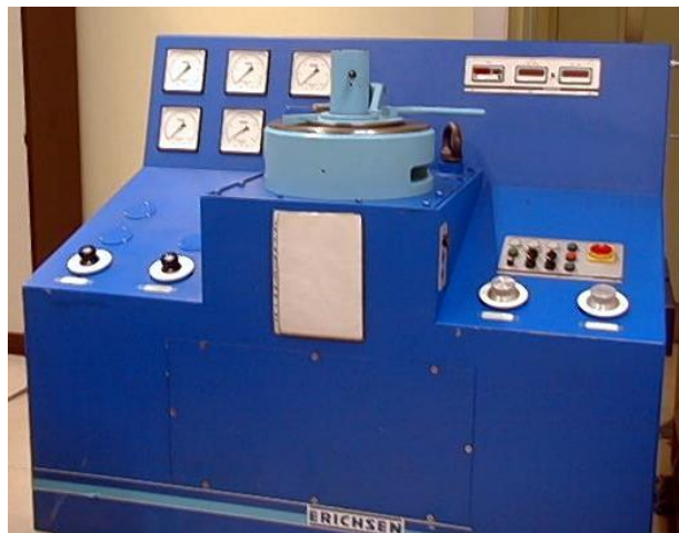
Figura 3.2 - Fotografia da máquina universal de ensaios de expansão biaxial (Cristino e Martins, 2013)
